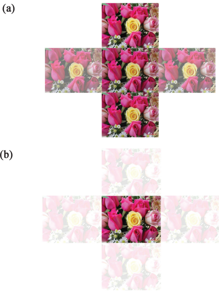
图 8 (a)宽视角模式下在上/下/左/右视角 80°的视角;(b)窄视角模式下在上/下/左/右视角 20°的视角.
